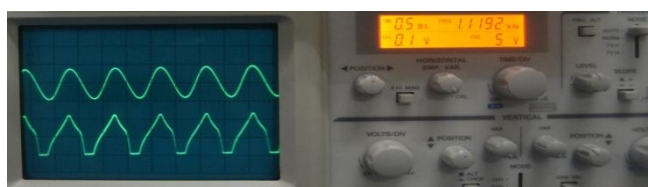
Gambar 11 . Output dan Input Sinyal dengan Frekuensi 1,049 kHz
