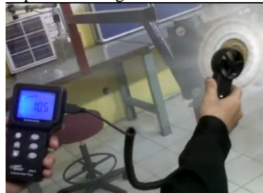
Gambar 9 Pengukuran kecepatan angin dengan Anemometer
