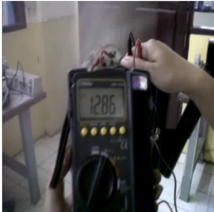
Gambar 7. Pengukuran tegangan dengan multimeter
