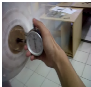
Gambar 8 Pengukuran kecepatan putaran dengan Tachometer
