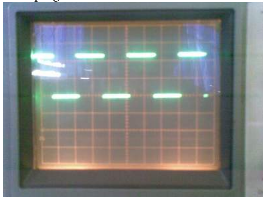
T/Div= 0,5 ms, V/Div= 1 V, Freq= 0,66 Khz, Gambar 11. frekuensi warna hitam dengan sudut 180°
