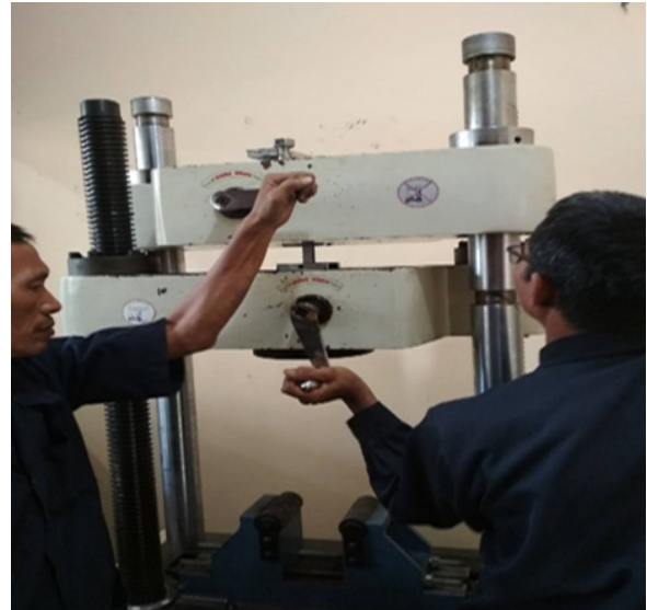
Gambar 5. proses pengujian tarik
