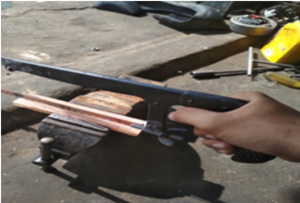
Gambar 3. proses pemotongan material komposit
