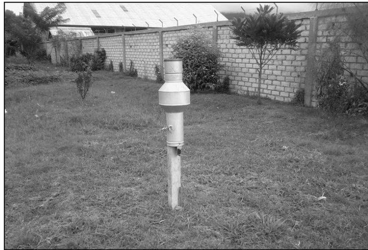
Gambar 2. Alat pengukur curah hujan
