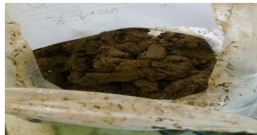
Gambar 2 Tanah yang sudah distabilisasi dengan kapur
