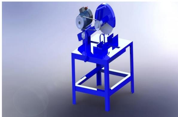
*Gambar 1. Desain Gambar Mesin Pemotong Lidi Tusuk Sate*
