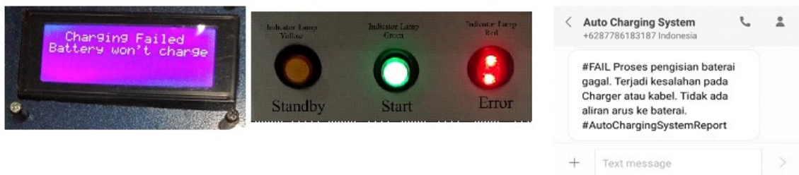
Gambar 10. Tampilan mode “fail” pada LCD, lampu indikator, dan SMS.
