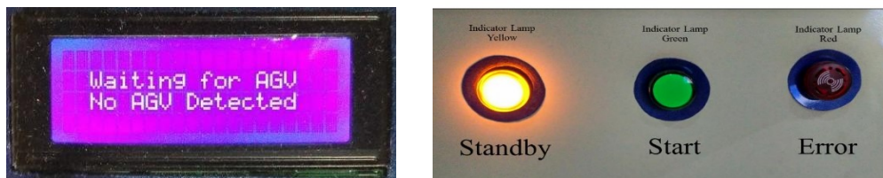
Gambar 7. Tampilan LCD dan indikator pada mode “ standby ”.
