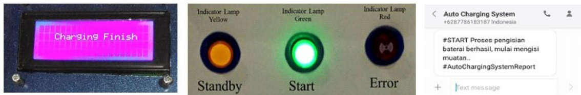
Gambar 8. Tampilan mode “ start ” pada LCD, lampu indikator, dan SMS.
