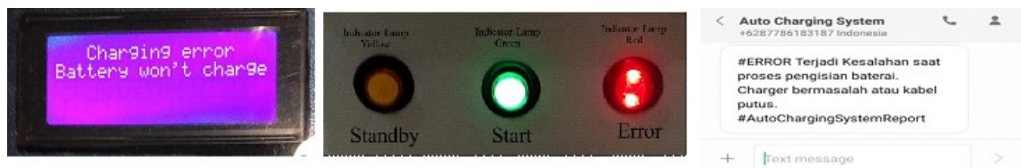
Gambar 11. Tampilan mode “error” pada LCD, lampu indikator, dan SMS.
