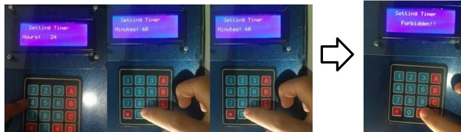
Gambar 6. Input data melebihi aturan sistem pewaktu.
