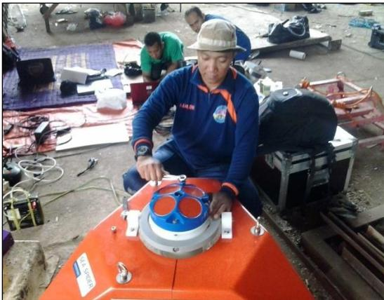
Pemasangan ADCP di Spider Seafloor Platforms atau dudukan ADCP Teledyne. Pada saat instalasi Spider Seafloor Platforms ADCP semua baut harus betul-betul sudah terpasang, sehingga pada saat ADCP di turunkan tidak akan terlepas dari Spider Seafloor Platforms, Gambar 3.6 berikut ini adalah pemasangan ADCP di Spider Seafloor Platforms atau dudukan ADCP Teledyne.
