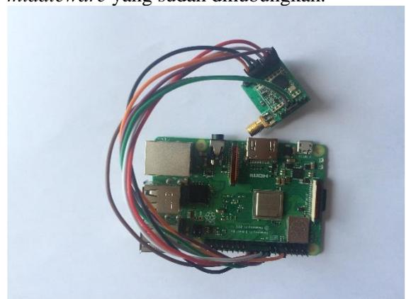
Gambar 2. Implementasi raspberry dengan modul LoRa
