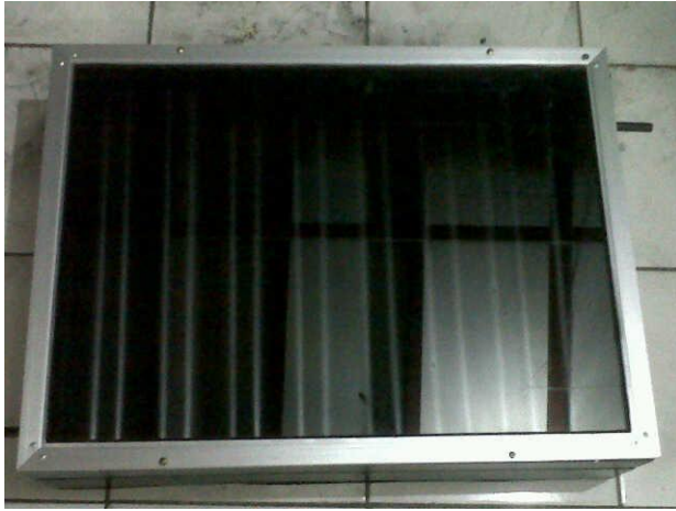
Gambar. 6 : Panel Kolektor Plat Bergelombang
