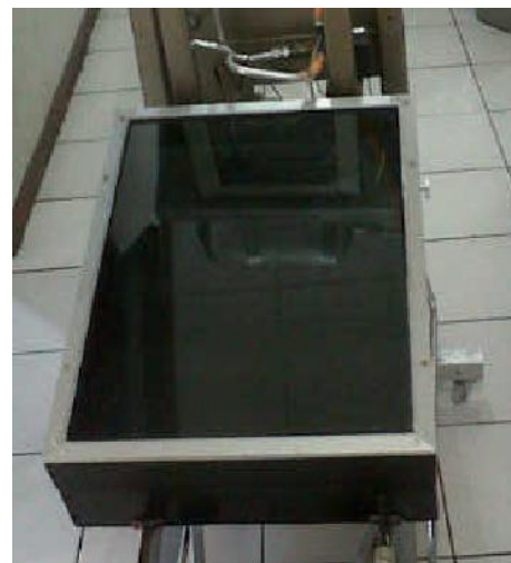
Gambar. 5 : Panel Kolektor Plat Datar
