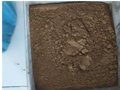
Gambar 2. Abu Terbang PLTU Tenayan Raya
