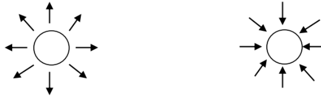
(a) Pergerakan berasal dari suatu zona (b) Pergerakan menuju suatu zona Gambar 1. Bangkitan dan Tarikan yang Berasal Dari/Menuju Suatu Zona [3]
