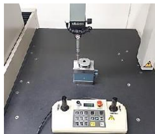
Gambar 4. Pengukuran ukuran linear produk uji dengan CMM
