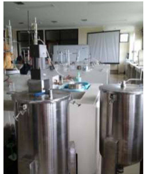
Gambar 2. Fermentor untuk Fermentasi Minuman Cuka Coklat
