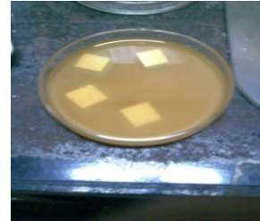
Gambar 4. Kaca yang sudah dilapisi larutan TiO 2 direndam dalam larutan dye
