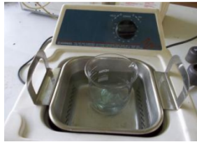
Gambar 1. Pembersihan kaca ITO menggunakan ultrasonic cleaner
