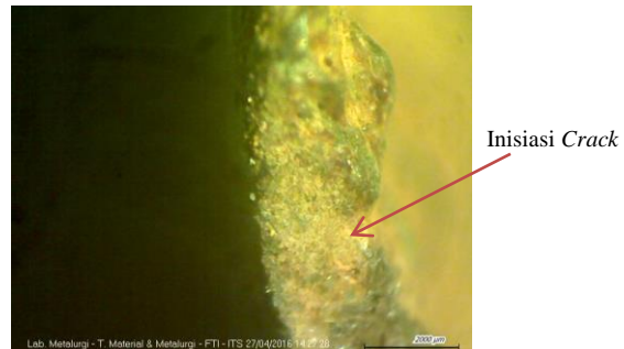
Gambar 5 Daerah initial crack (a) diambil dengan mikroskop stereo perbesaran 10x
