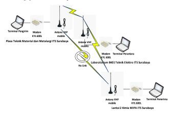
Gambar 5. Konfigurasi Peralatan Pengujian Protokol pada Kanal VHF
