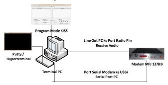
Gambar 4. Konfigurasi Peralatan untuk Demodulasi Data Radio Paket
