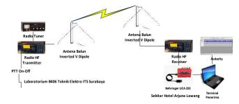
Gambar 3. Konfigurasi Peralatan Perekaman Sinyal Carrier
