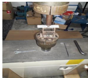
Gambar 3.5 Pengujian Uji Lengkung ( Bending ) Untuk Chasis Gokart
