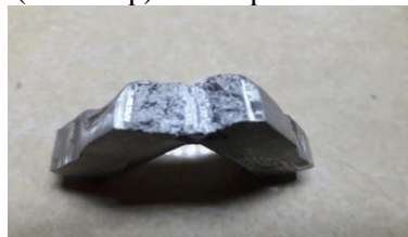
Gambar 3.2 Spesimen Uji Impact Dengan Kampuh I Tertutup Arus 80 Ampere
