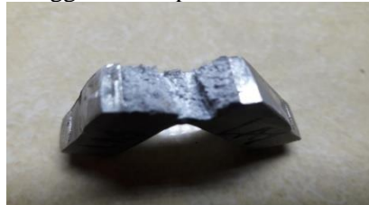
Gambar 3.4 Spesimen Uji Impact Kampuh Tirus Tunggal Arus 80 Ampere
