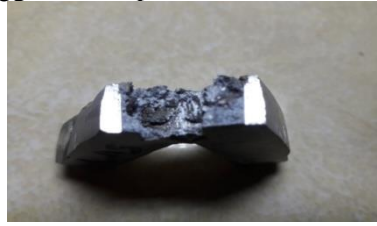
Gambar 3.3 Spesimen Uji Impact Kampuh V Tunggal Arus 80 Ampere
