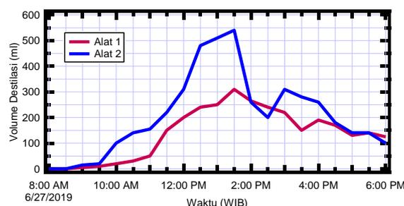
Gambar 4.7 Grafik perbandingan volume destilasi aktual alat 1 dengan volume destilasi aktual pada alat 2
