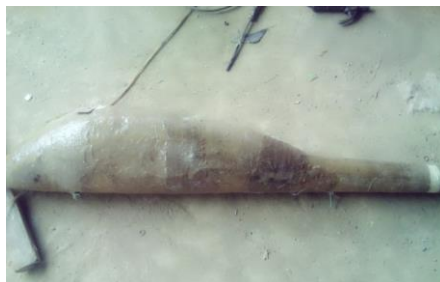
Gambar 3.2 tampilan badan pesawat setelah di resin
