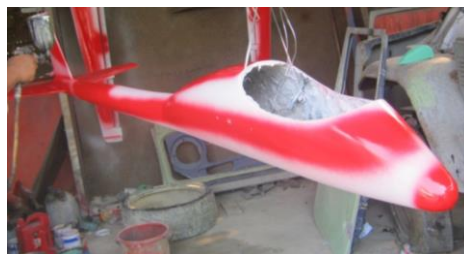
Gambar 3.6 tampilan hasil proses pengecatan tahap kedua
