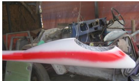
Gambar 3.5 tampilan hasil proses pengecatan tahap pertama
