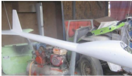
Gambar 3.4 tampilan hasil permukaan setelah di polishing
