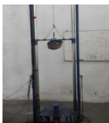
Gambar 7. Posisi anvil, helmet sepeda dan test rig
