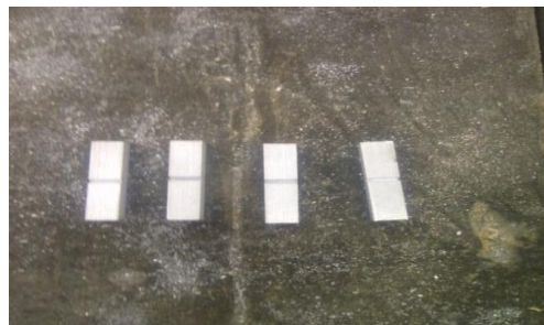
Gambar 8. Spesimen uji impact yang belum di uji
