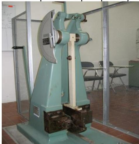
Gambar 1 mesin uji impak
