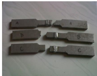
Gambar 2 Spesimen setelah diuji tarik.
