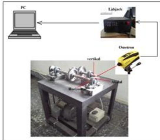
Gambar 3.3. Rangkaian analisa pengukuran data
