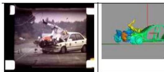
Gambar 1. Tabrakan sepeda motor dengan mobil pada sudut 90° [1]
