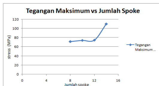
Gambar 10. Grafik tegangan maksimum vs jumlah spoke untuk velg tanpa penambahan ketebalan daerah flange
