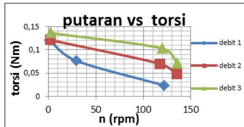
Dari grafik putaran vs torsi didapat hubungan antara putaran (rpm) terhadap torsi (Nm) pada masing-masing debit air masuk. Didapat torsi maksimum pada sudu II dengan debit 0,005 m<sup>3</sup>/s dan putaran 2,2 rpm sebesar 0,268 Nm. Torsi maksimum pada sudu III dengan debit 0,005 m<sup>3</sup>/s dan putaran 2,4 rpm sebesar 0,137 Nm. Putaran vs efisiensi Pada Sudu II
