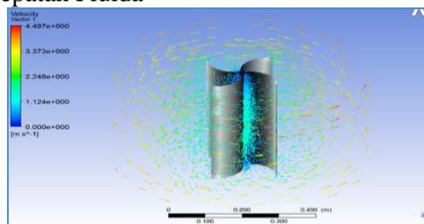
Gambar 4.5 vektor kecepatan fluida
