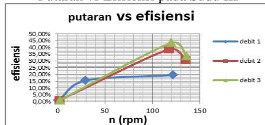
Dari grafik putaran vs efisiensi didapat hubungan antara putaran n (rpm) dengan efisiensi (%) pada masing-masing debit air masuk, didapat efisiensi maksimum pada sudu II dengan debit 0,005 m<sup>3</sup>/s dan putaran 60,5 rpm sebesar 40,88 %. Efisiensi maksimum pada sudu III dengan debit 0,005 m<sup>3</sup>/s dan putaran 120 rpm sebesar 43,29 %.
