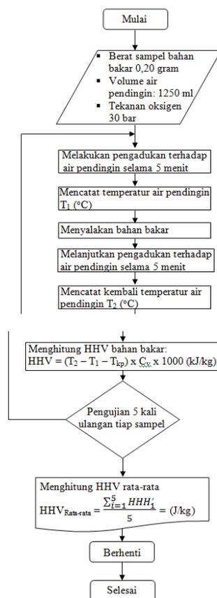
Gambar 3.2 Diagram Alir Pengujian Nilai Kalor Bahan Bakar[4]
