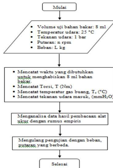
**Gambar 3.4** Diagram Alir Pengujian Performansi Motor Diesel
