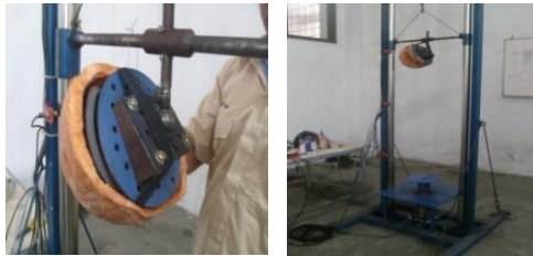
Gambar 3.1. Pemasangan helmet sepeda pada tes rig
