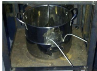
Gambar 7 Keterpasangan elemen pemanas dengan bejana aduk
