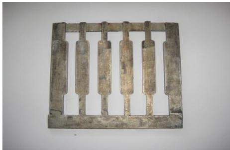
Gambar 1. Cetakan spesimen uji tarik
