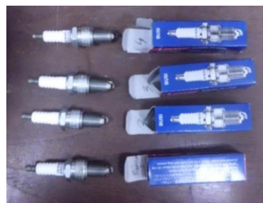
Gambar 4.5 Busi yang akan digunakan dalam pengujian saat menggunakan bahan bakar premium
