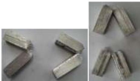
Gambar 3 ; bentuk patahan sampel uji impak
