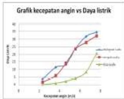
Gambar 4.3 Grafik kecepatan angin vs daya listrik pada beban 10 watt
