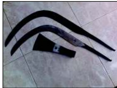
Gambar 1. Peralatan panen buah kelapa sawit (egrek dan dodos) produk lokal dan produk import
