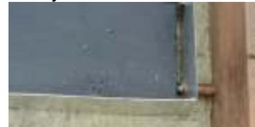
**Gambar: 9 Setelah di pasang pipa ke sisi papan**
