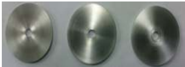
Gambar 1. Spesimen uji bahan Aluminium sekrap, Al-Si 3,76% dan Al-Si 9,12% sebelum dilakukan uji keausan
