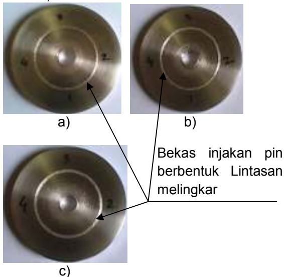
Gambar 3. Spesimen uji bahan a) Aluminium sekrap, b) Al-Si 3,76% , c)Al-Si 9,12% setelah dilakukan uji keausan
