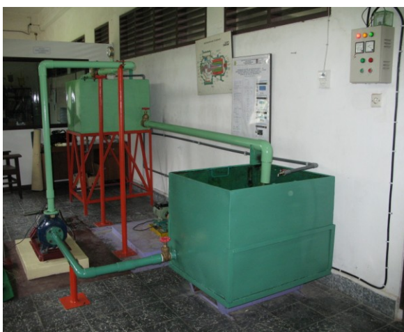
Gambar 7. Gambar instalasi pompa
