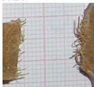
(c). Permukaan patah spesimen komposit polimer diperkuat serat sabut kelapa
