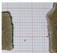
(b). Permukaan patah spesimen komposit polimer diperkuat serat pelepah pisang
