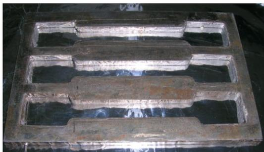
Gambar. 1. Cetakan spesimen uji tarik
