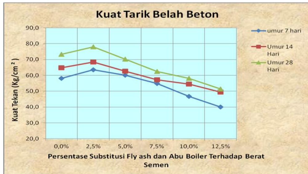
Gambar 4.6 Hubungan kuat tarik belah beton dengan substitusi abu boiler dan fly ash terhadap berat semen (M.Reza, 2014)
