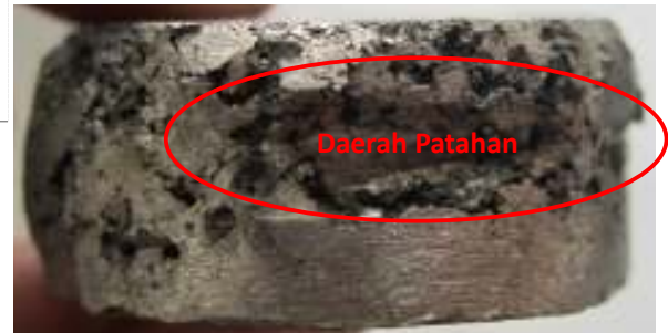
Gambar 5. Spesimen Al Foam yang mengalami patah getas
