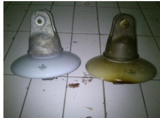
Gambar 3. Kondisi Isolator Piring Terpolusi Asap Pembakaran
