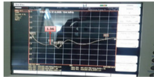
Gambar 8. Tampilan Pengukuran VSWR
