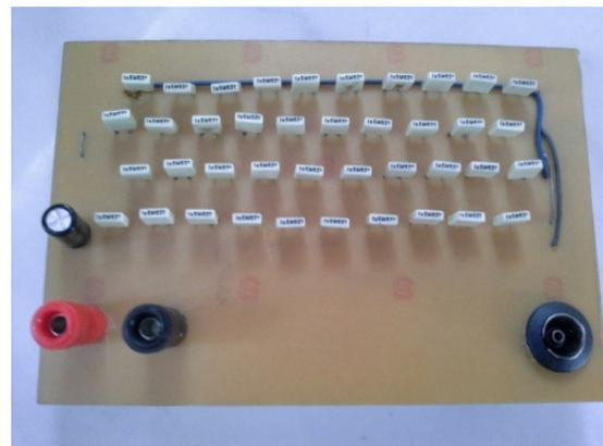
Gambar 7 *Power Harvester 20-stage* (atas)
