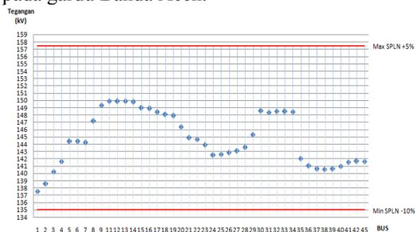
Gambar 5. Profil tegangan bus beban pada 10% beban puncak
