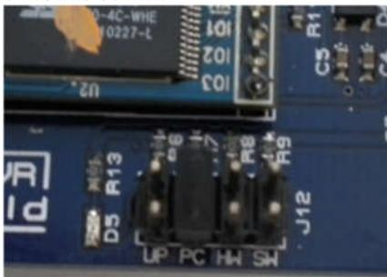
Gambar 3. Posisi *jumper* (J12) pada *PC - connection mode*.
