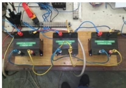
Gambar 10 ZSBT Dengan Belitan Bifilar yang Digunakan Pada Eksperimen
