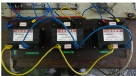
Gambar 9 ZSBT Dengan Belitan Konvensional yang Digunakan Pada Eksperimen
