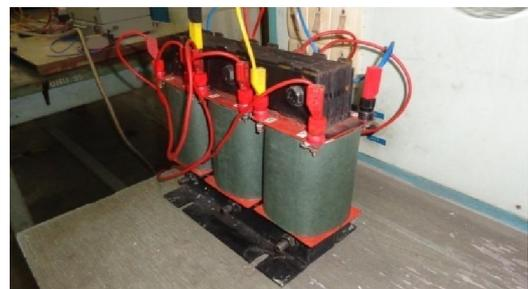
Gambar 7 Transformator Wye-Delta yang Digunakan Pada Eksperimen
